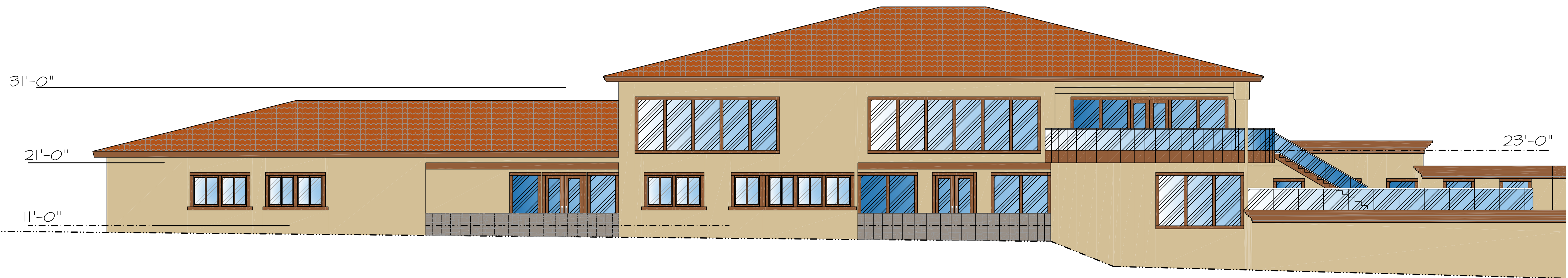
EAST ELEVATION SCALE: 1/8" = 1'-0"
